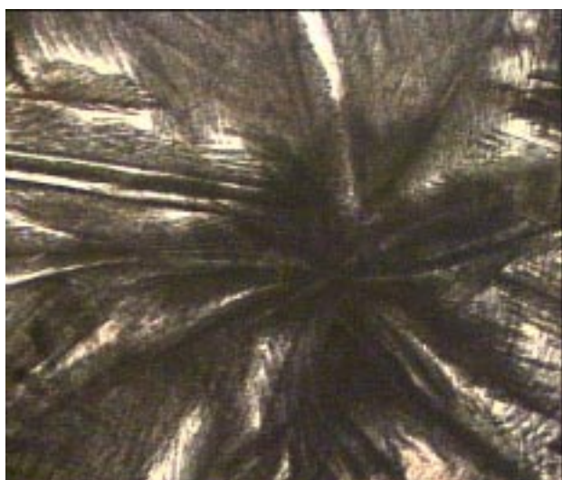
Рис. 1. Диопсид-волластонитовые сферолиты в матрице тенгизитового стекла. Шлиф, николи параллельны.
